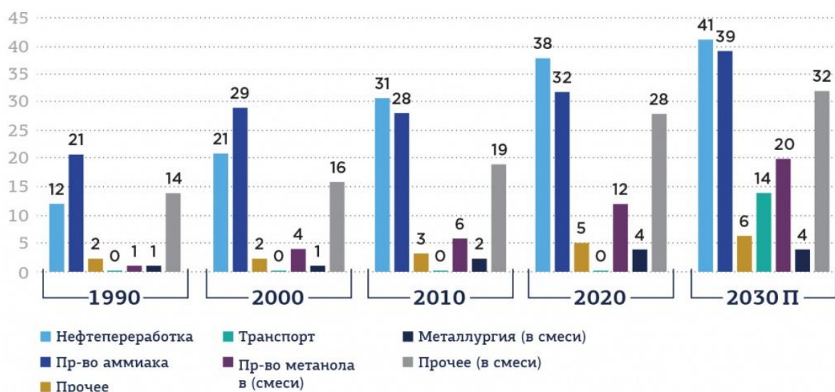
Рис. 6. Динамика потребления чистого водорода и водорода в смеси в мире по сегментам производства, млн т.
